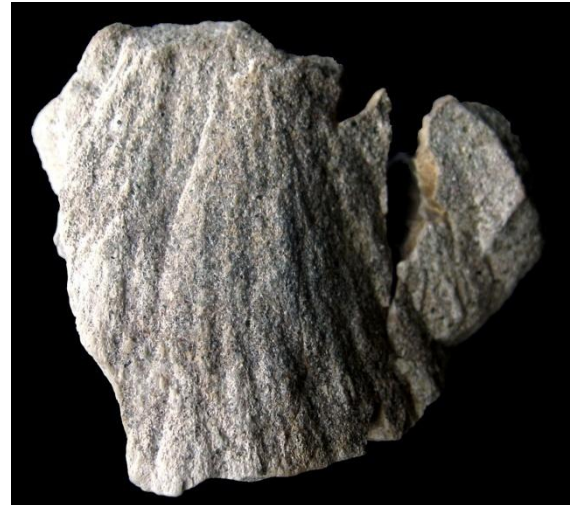
Abb. 7. Oberjura-Kalkbrocken mit deutlicher Shatter-Cone-Striemung (Strahlenkalk G) aus dem Kleintobel. Ravensburger Brockhorizont bei etwa 449,3 Meter ü. NN. Maße des Strahlenkalkes: 6,0 x 4,5 x 2,5 Zentimeter.
