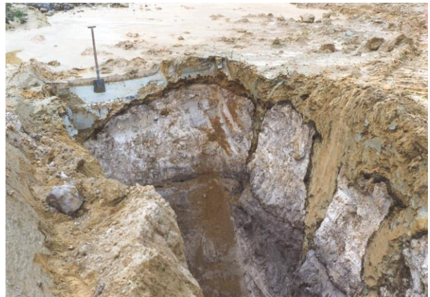
Abb. 2. Ansicht der Baggerschürfung auf der untersten Sohle der Altheimer Grube. An den Wänden des fünf Meter tiefen Aufschlusses zeigen sich die beschriebenen, neuen Sedimentstrukturen (Loading Fractures).
